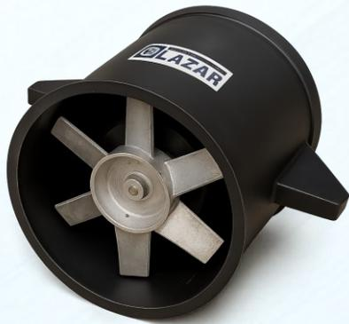
Los ventiladores industriales **LAZAR modelo SXF** están concebidos para aplicaciones de extracción en condiciones ambientales severas. Su diseño incorpora un sistema de **motor encapsulado y fuera de la corriente de aire**, lo que protege al motor del contacto directo con contaminantes como humedad, grasa, partículas en suspensión, vapores corrosivos o gases calientes. Esta característica incrementa significativamente la confiabilidad operativa del equipo en entornos agresivos.
